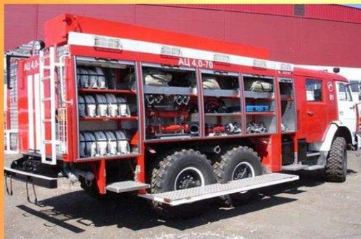
Пожарные машины снабжены цистерной с водой, баком со специальной пеной, длинными шлангами – рукавами, складной лестницей. Еще у пожарной машины есть сирена и мигалка.
